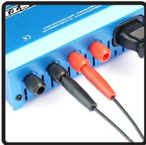
1.電源入力コードを電源に接続します。(DC 7.2~13V)
